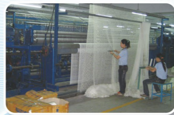
④ Checking & Mending » 巡補網片
